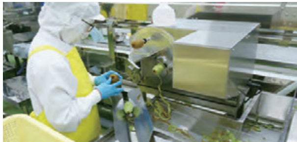
コンベアに載って流れてきた外装殺菌された多品種のフルーツを安全に安定的に処理する高度オーダーメイド機器。
