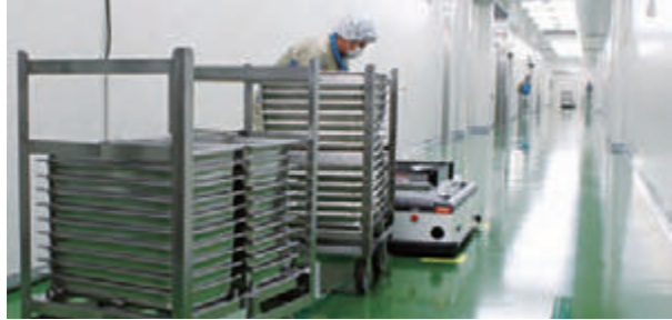
下処理した食材を運ぶための自動搬送機。運行エリアに人や障害物があると検知して止まる、安心の障害物検出センサー付き。
